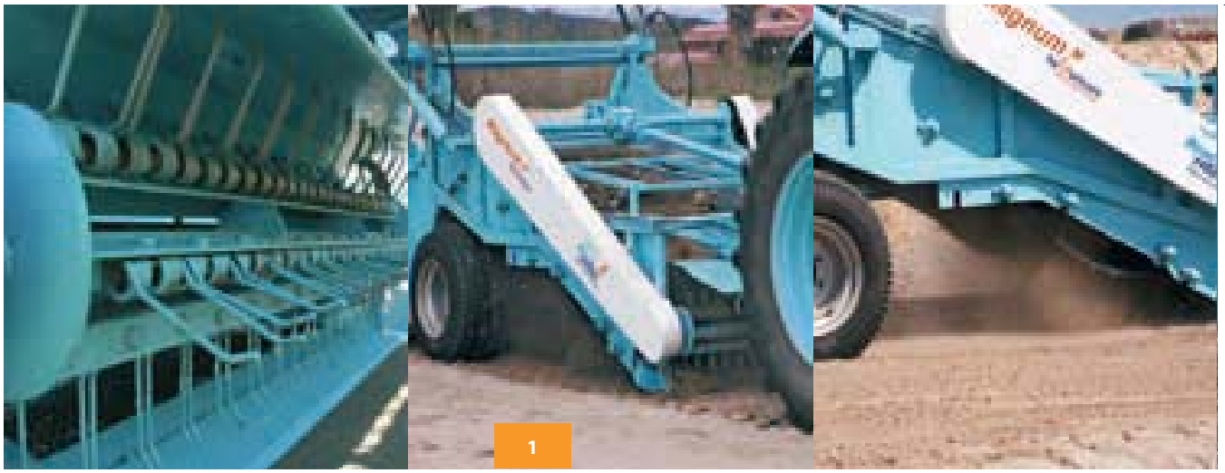
Puas cincadas y flexibles Flexible, zinc-coated bars
